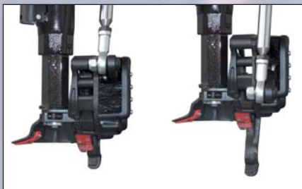
Integrierter Demontagefinger macht das Montiereisen überflüssig
