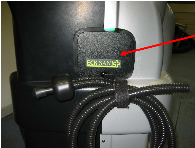
Verschlusskappe des Tanks für das Desinfektionssystem und Anschlusschlauch
